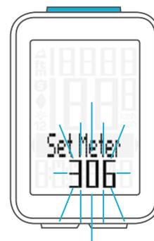
Mit der **BIKE-Taste erhöhen** Sie den Wert.
