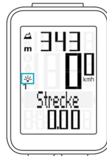
**Bei jedem Tastendruck** wird im aktivierten Licht-Modus das **Licht** im Display **für ein paar Sekunden eingeschaltet**. Mit dem nächsten Druck auf die Taste wird die gewünschte Funktion im Display angezeigt.
