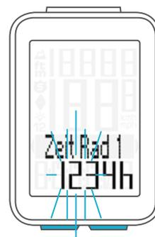
Danach wird die **Einstellung** für die **Minuten** geöffnet. Mit der **BIKE-** oder der **ALTI-Taste** stellen Sie die Minuten ein.
