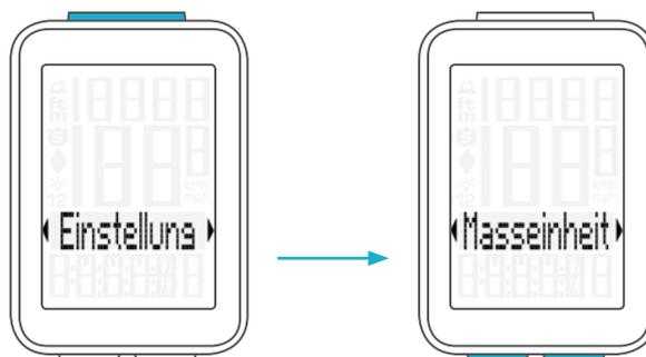
Die Einstellung der Maßeinheit öffnen Sie mit der **SET-Taste**.
