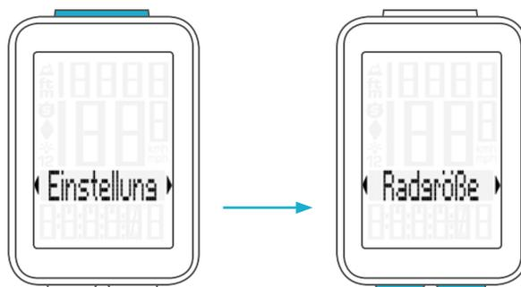
Mit der **SET-Taste** öffnen Sie die Einstellung für die **Radgröße**.
