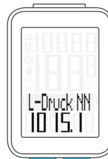
Wenn der korrekte Wert der Starthöhe eingestellt ist, bestätigen Sie die Einstellung mit der **SET-Taste**.
