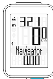
**Halten Sie, wenn die Navigator-Funktion im Display ist, die SET-Taste gedrückt**, bis das Einstell-Menü geöffnet wird.
