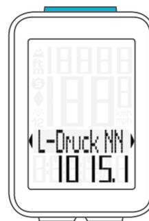
Mit der **BIKE-Taste erhöhen** Sie den Wert.
