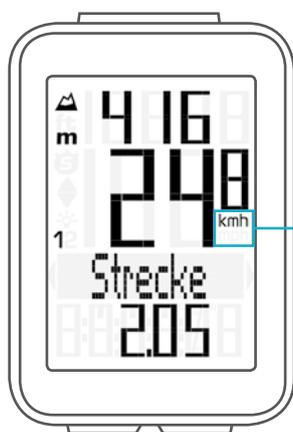
Im rechten Display-Bereich, unterhalb der Geschwindigkeitsanzeige, wird die Masseinheit kmh oder mph angezeigt.
